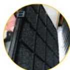
Il filtro dell'aria in schiuma compatta permette di lavorare in spazi molto polverosi
